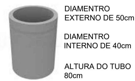
ESPECIFICAÇÃO DA LIXEIRA DE CONCRETO ESC.: S/E
